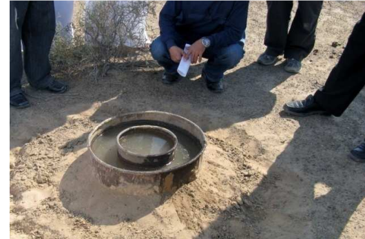
الشكل 15: قياس معدل الرشح السطحي باستخدام مقياس الرشح ثنائي الحلقات.
