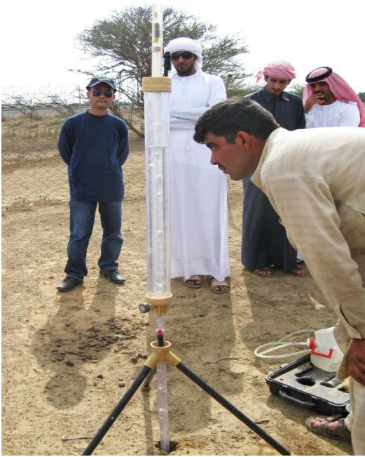
الشكل 16: قياس التوصيل الهيدروليكي المشبع باستخدام مقياس الجيلف.
